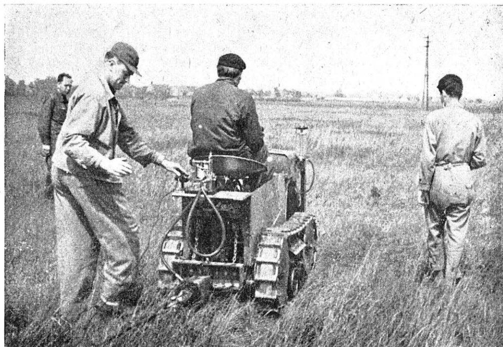
Obr. 1. Traktor PT. při tahových zkouškách na úhuru 10
