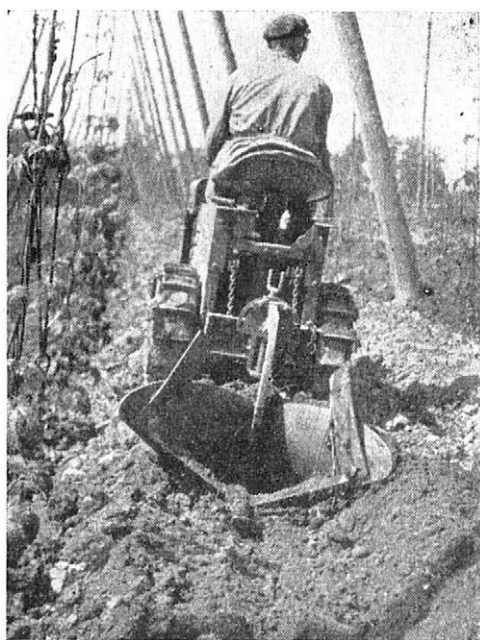
Obr. 3. Traktor PT 10 při meziřádkovém obdělávání chmelnic. Snímky VÚZCH Zatec
