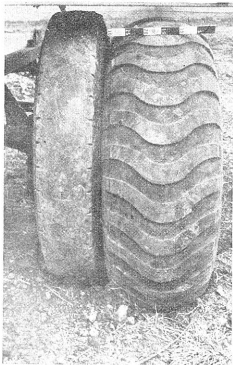
24. Možné nadrozměrné oráfování vleků: 13,00—14 vedle staré standardní velikosti 190—20.
