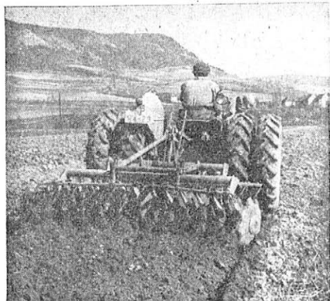
12b. ...zatímco při nadměrných dvojitých pneumatikách a při sníženém tlaku vzduchu zůstává profil čistý.
