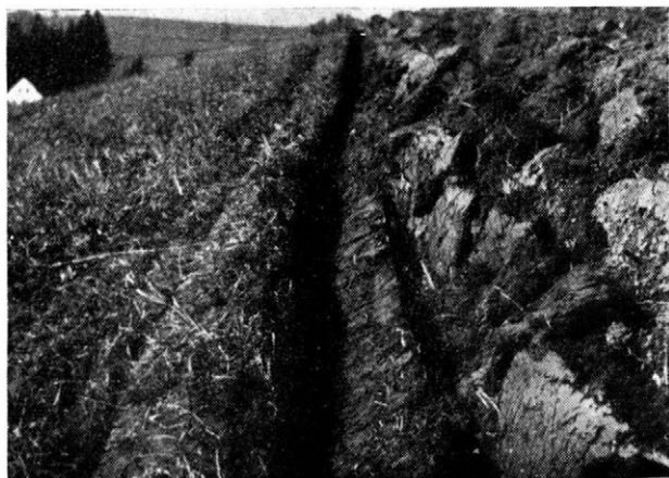
5. Pohled na schodovité dno brázdy vytvořené při orbě prototypem horského orebního tělesa
