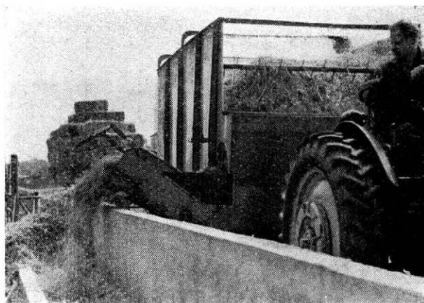
16. Krmný vůz s pásovým dnem a příčným transportérem pro zelené krmení (Výzkumný ústav zemědělské techniky).
