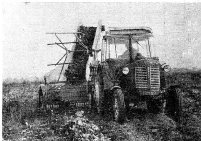
4. Žací nakladač píce E-062, upravený pro sběr chrástu z podélných řad.
