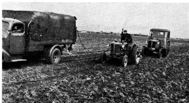
22. Současné měření krouticích momentů a tahové síly u traktoru Z-25A na podmítnutém poli.
