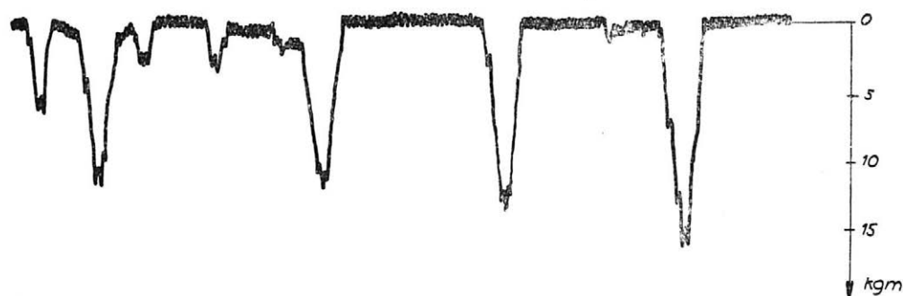
1. Průběh krouticího momentu klikového mechanismu žacího ústrojí
