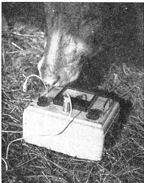
8. Termistorový teplomer vyvinutý na našom pracovisku o rozsahu -5 až +60^{\circ}\text{C}
