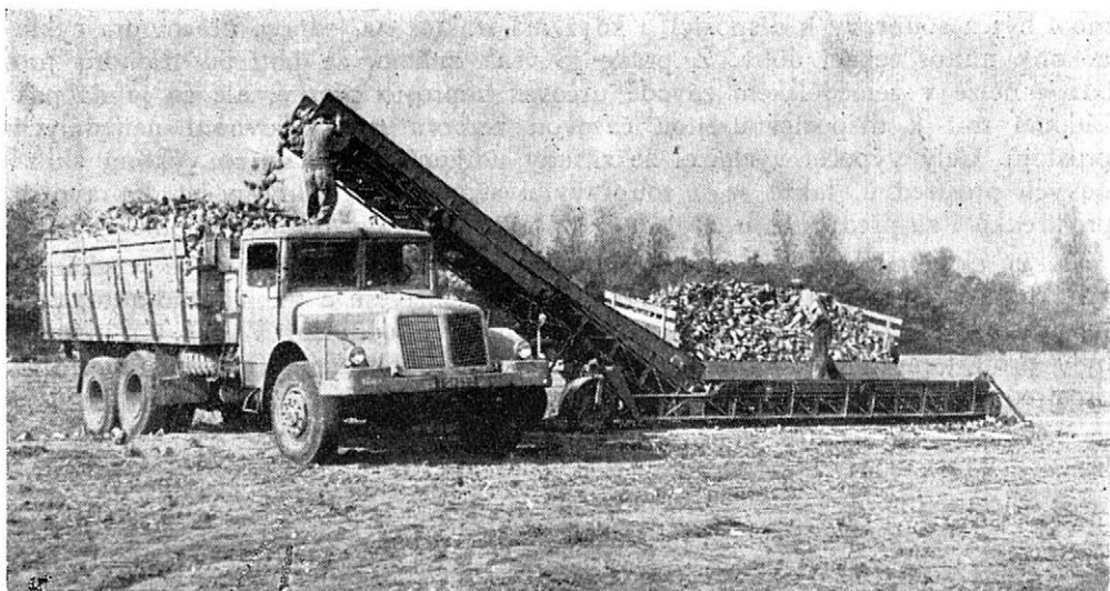
6. Překládací dopravník pro překládku bulev z přívěsů do nákladních automobilů. Dopravník je umístěn na souvrati a celou manipulaci s překládkou obstarávají dva muži
