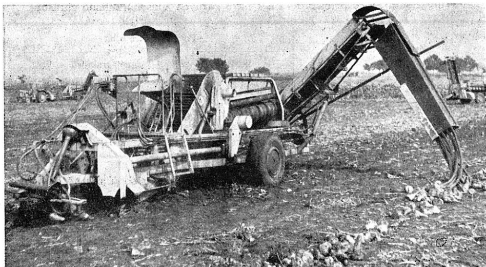
3. Sklízeč bulev 2 VCZ, upravený pro třířádkovou sklizeň. Nakládací dopravník je opatřen řádkovací clonou pro řádkování bulev z osmi až deseti řádků do podélné řady
