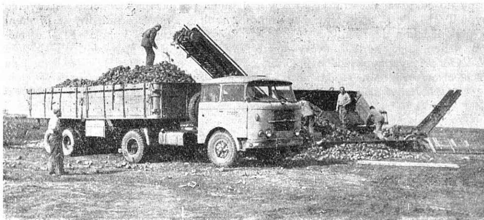
8. Po naplnění je návěs navěšen za tahač a odvezen do cukrovaru, zatímco na jeho místo se přistaví návěs prázdný
