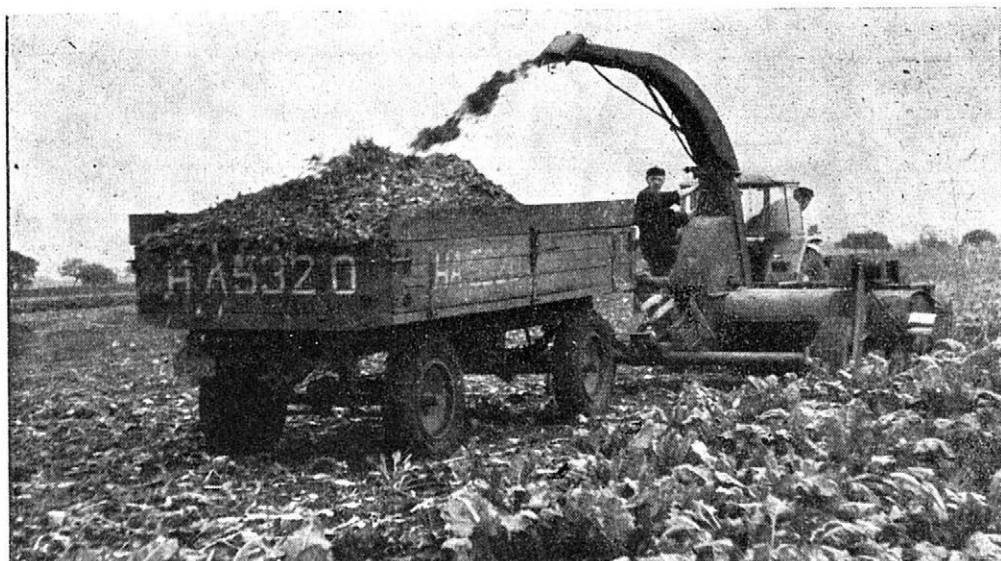
1. Kombinovaný cepový sklizeč píce SPKZ 160 s adaptérem pro seřezávání chrástu dopravuje pořezaný chrást výfukem do přívěsu s nástavky
