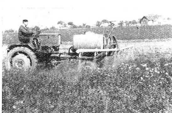
2. Plošný rám Desiko na postřikovači S 293 při práci
