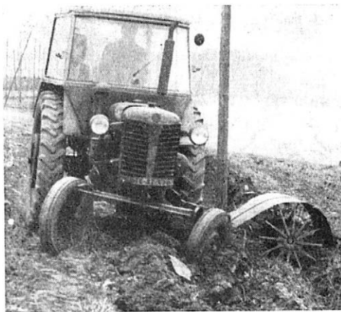
13. Sjetí traktoru s výkyvným ramenem na odkopávku sloupových řadů do brázdy ve svahu 11,1° na chmelnici č. 84 v Solopyskách
