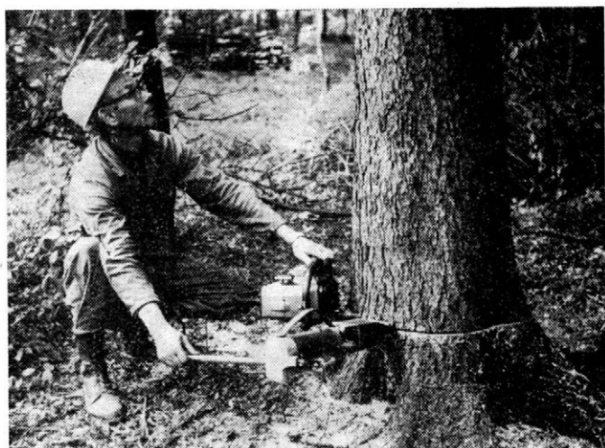
11. Samostatná práce při kácení stromu za použití hydraulického klínu
