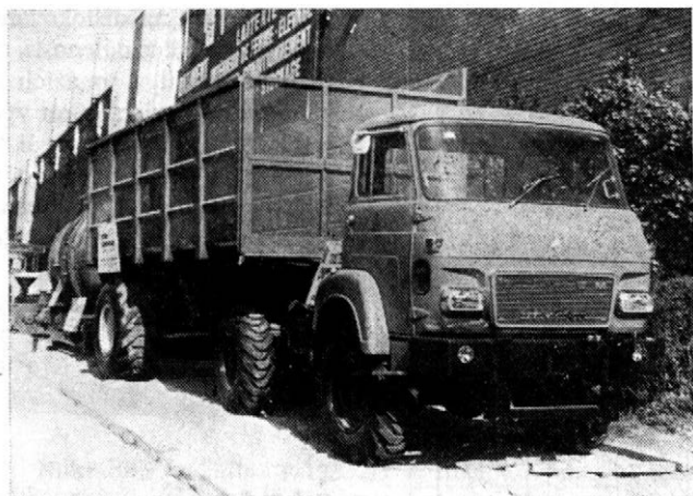
5. Tahač Saviem — Sinpar s návěsem na objemové hmoty o nosnosti 10 t a ložném objemu 20 m 3
