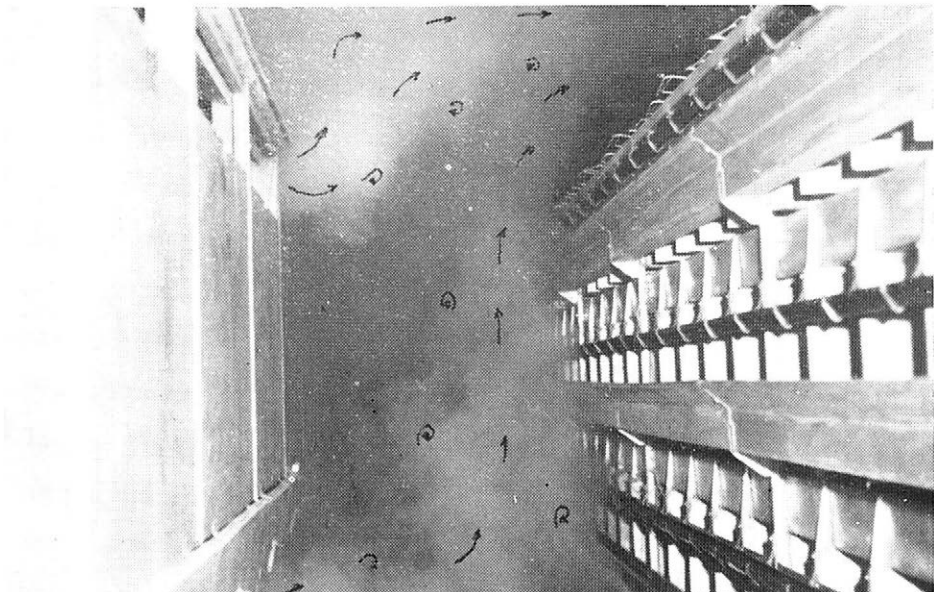
2. Zviditelnění výstupních proudů vzduchu z krytu štěrbin při otevření dolních i horních klapek v první fázi zkoušky; vzduch proudí z obou otvorů vzhůru ke stropu a nevstupuje do klení; pro zviditelnění je použito ochlazeného dýmu dýmovnice.
