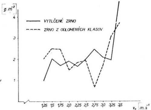
6. Priebeh strát zrna v závislosti na požadovanej rýchlosti riadkovej kosačky V_s
