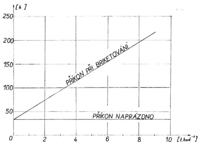
1. Závislost příkonu na výkonu mobilního briketovacího lisu
