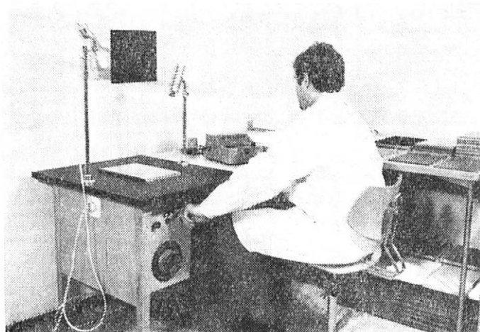
7. Pohľad na laboratórny prístroj "Albédomer" vyrobený ako prototyp na Ústave stavebníctva a architektúry SAV v Bratislave
