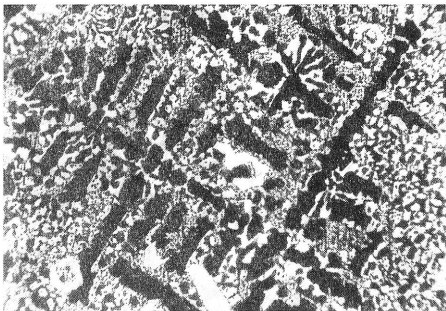
7. Dendritická struktura návarového materiálu, zv. 500X, lept. 50 ml HCl, 25 ml HNO 3 , 150 ml H 2 O, 1 g CuCl 2
