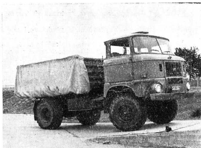
1. Měřicí vozidlo pro zjišťování ztrát zrna, způsobených netěsnostmi ložného prostoru
