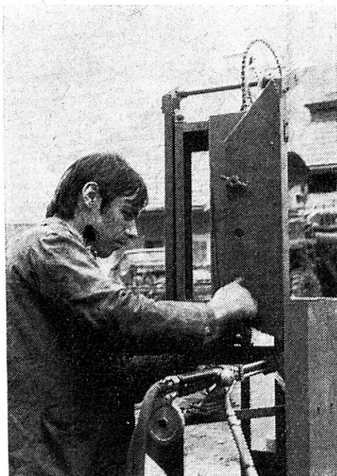
14. Prototyp vertikálního kalícího přípravku
