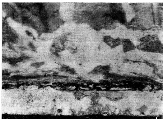
1. Deformovaná oblasť opotrebeného povrchu lemeša (500 X)
