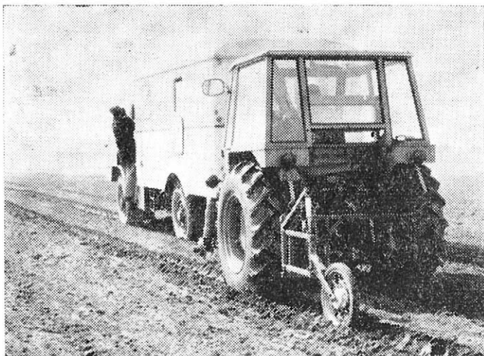
7. Zadní boční pohled na měřicí soupravu při druhém průjezdu hnacích kol v téže stopě
