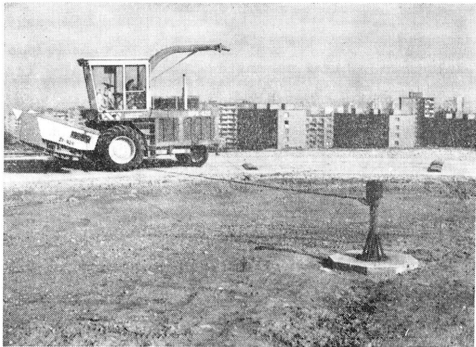
2. Spojení zkoušeného stroje se středovým sloupem řídicím lanem a elektrickým kabelem
