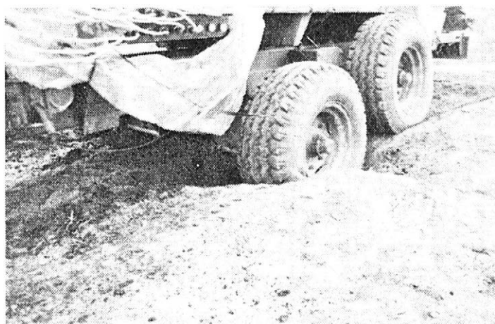
5. Pohled na tandemovou nápravu rozmetadla RM-10 při přejezdu příkopu hlubokého cca 40 cm — A view of the tandem axle of the RM-10 distributor crossing a ditch ca. 40 cm in depth
