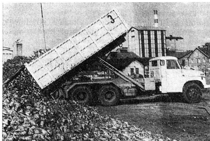
7. Vykládka cukrovky z kontejneru zadním sklápěním v cukrovaru — Rear tilting — sugar-beet being unloaded from the container in a sugar-factory
