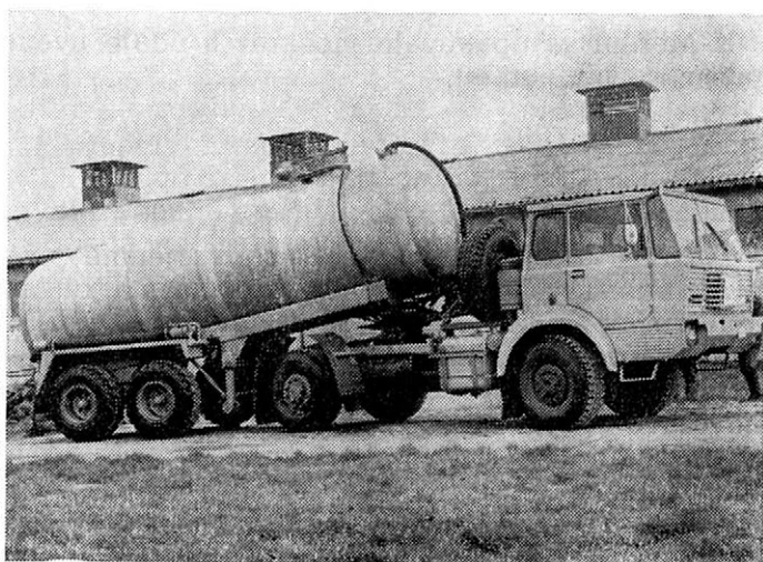
2. Návěšová fekální cisterna HLS 150.27 s tahačem T 813 — Semi-trailer faecal tank HLS 150.27 with off-the-road tractor T 813
