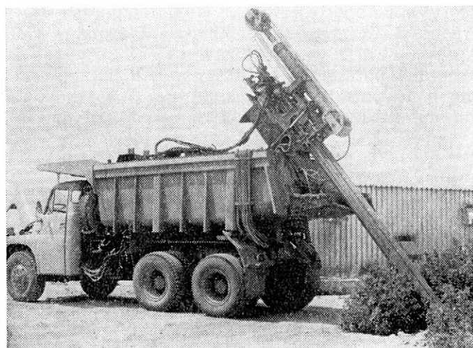
5. Samonakládací automobilový přepravník trusu drůbeže Jegris — Self-loading poultry dung transport container Jegris
