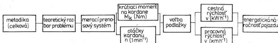
1. Schéma metódy merania energetickej náročnosti náhonu — System of measuring the energy consumption of the drive
