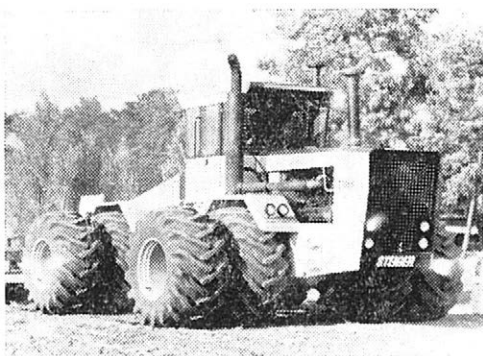
1. Kolesový traktor firmy Steiger typ TIGER III, ST-450 o výkone motora 330 kW
