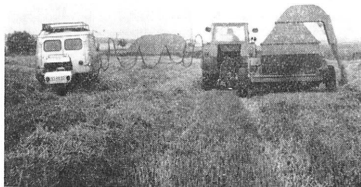
6. Mobilní štípač slámy s adaptérem na zdvojování řádků — měření energetické náročnosti — Mobile straw cutter with an attachment for row doubling — energy consumption measured
