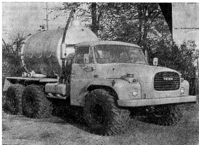
10. Upravený podvozek nákladního automobilu Tatra 148 s flotačními pneumatikami a fekální cisternou (M.A.M. Strager Francie) — Adapted chassis of the Tatra 148 truck with flotation tyres and faecal tank (M.A.M. Strager, France)
