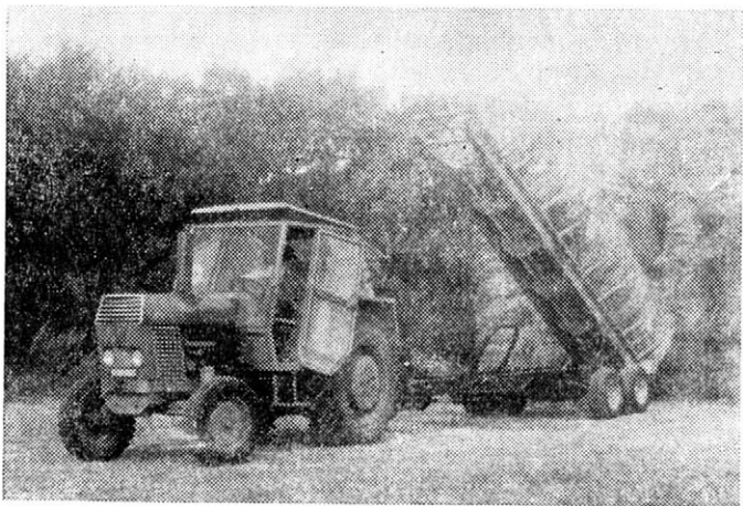
3. Návěs ke sběru, naskladnění a vyskladnění obřích balíků OMAS — The OMAS trailer for big bale picking, loading and unloading
