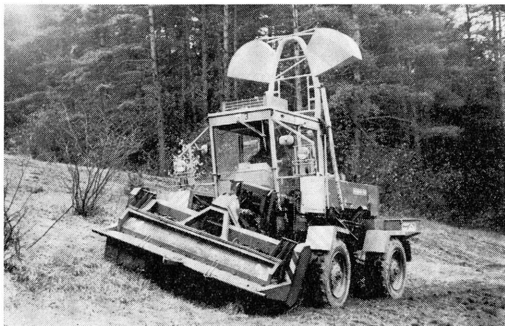
1. Stroj pro mechanizaci pícninářských prací na svazích v sestavě pro obnovu a ošetření — A machine for mechanical grassland management on slopes with attachments for grassland regeneration and treatment
