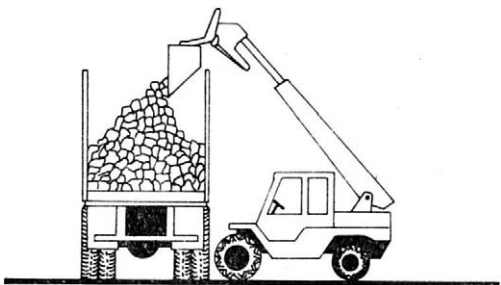
5. Nakládka nakladačem JCB 525-4 na dopravní prostředky — Loader JCB 525-4 is loading the conveyances
