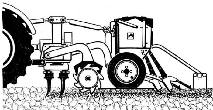
2. Schéma sečího stroje AMAZONE s nářadím na zpracování půdy
