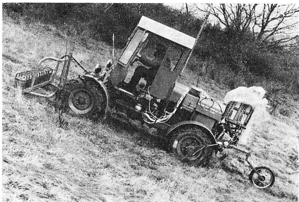
3. Měřicí jízda experimentálního stroje se simulátorem čelního přípojného stroje na svahu (na znázorněném místě 24^\circ ), který je měřen gyroskopem; telemetrický systém přenáší údaje v digitálním tvaru do stacionárního měřicího vozu (listopad 1980) — Test run of an experimental machine with an implement simulator on the gradient that is measured by means of a gyroscope; a telemetric system transmits the data in digital form to a stationary measuring van (November 1980)
