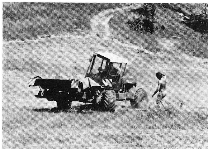
5. Měření průjezdu stroje zatáčkou ve tvaru U na svahu o sklonu 26^\circ (stroj SNG s neseným žací adaptérem podle obr. 1, 1983) — Measurement of the machine passing through a U-shaped curve on a 26^\circ slope (SNG machine with a mounted mowing adapter according to Fig. 1, 1983)
