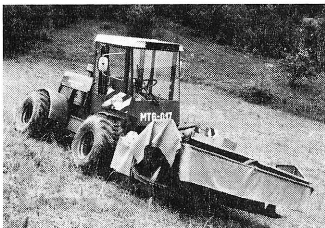
1. Stroj SNG s čelně neseným rotačním žacíím strojem SP2-210 na svahu 26° (1982) — The SNG machine with the SP2-210 front-mounted rotary mower on a 26° slope (1982)
