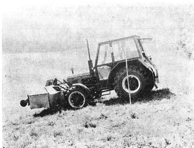
2. Traktor Z-7045 H s čelně neseným rotačním žací strojem SP2-201 na svahu 16° (1983) — The Z-7045 H tractor with the SP2-210 front-mounted rotary mower on a 16° slope (1983)
