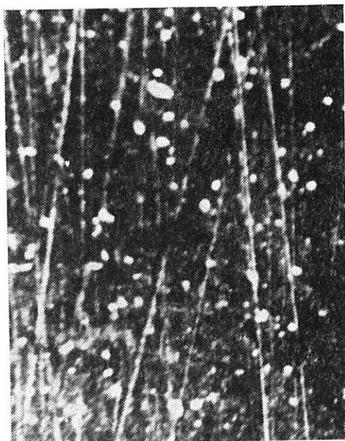
2. Mikrostruktura vnitřního povrchu nové strukové gumy — Microstructure of the inside of a new teat-cup liner
