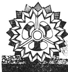
3. Působení prizmatického válce na půdu. Prizmatické válce půdu ve spodní zóně utužují, v horní zóně ji kypří
