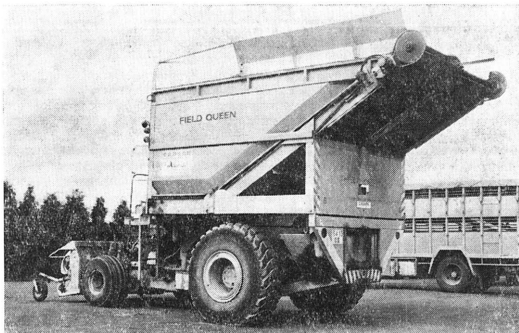
6. Samojízdná sklízecí řezačka s neseným zásobníkem o užitečné hmotnosti 8 t typu Field Queen 7655 — Self-propelled chopper-harvester with a mounted bin (storage capacity 8 t), Field Queen 7655 type
