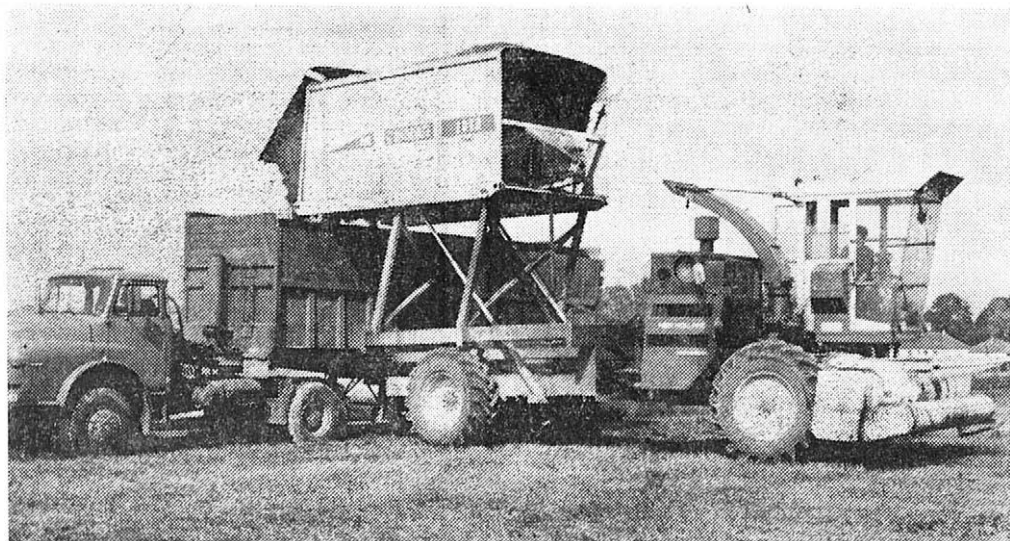
1. Samojízdná sklízecí řezačka se zásobníkem při překládce nákladu do těžkotonážní automobilové návěsové soupravy na okraji pole — A self-propelled chopper-harvester with a bin emptied into a heavy-weight truck-trailer set on the field margin
