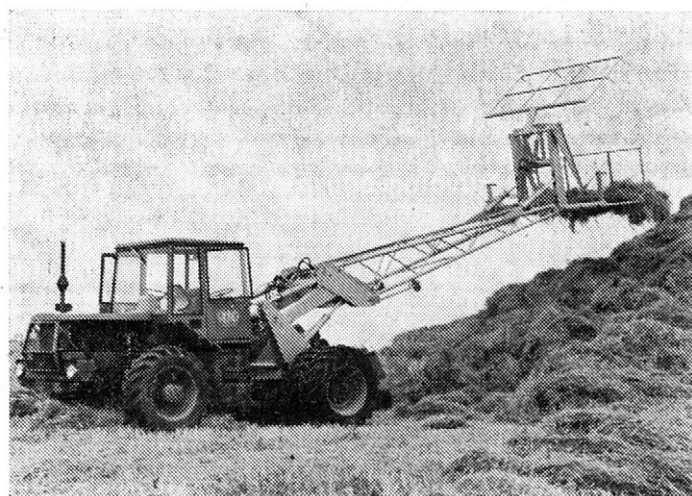
5. Stohování slámy stohářem na ŠT 180 N — Straw stacking with a stacker mounted on the ŠT 180 N tractor
