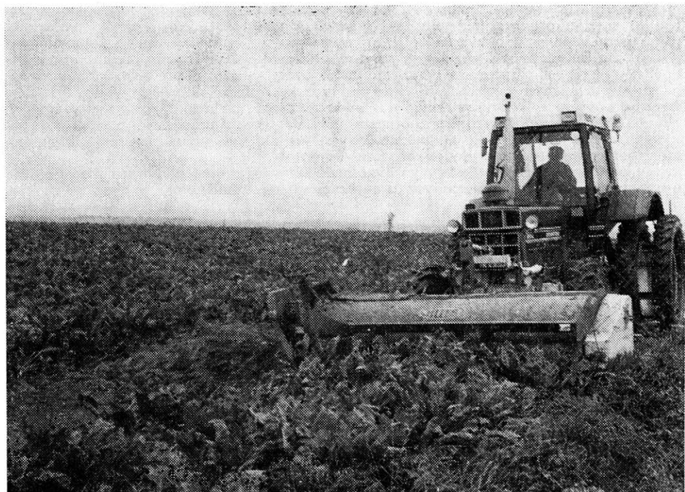
9. Traktor s vpředu neseným odlišovačem a vzadu neseným vyoravačem, s dvojmontáží zadních pneumatik s mezikusem
