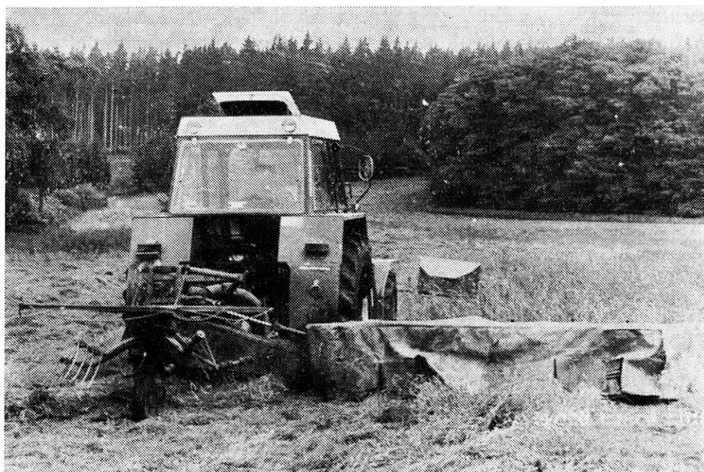
1. Talířový žací stroj — pohled na stroj s čechracím zařízením v pracovní poloze — Disk mower — a view of the machine with a tedder in working position
