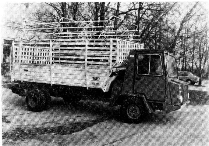
2. Univerzálna horská hnacia jednotka MT 6-063 s nadstavbou ASN-055 — Universal hillside power unit MT 6-063 with the superstructure ASN-055
