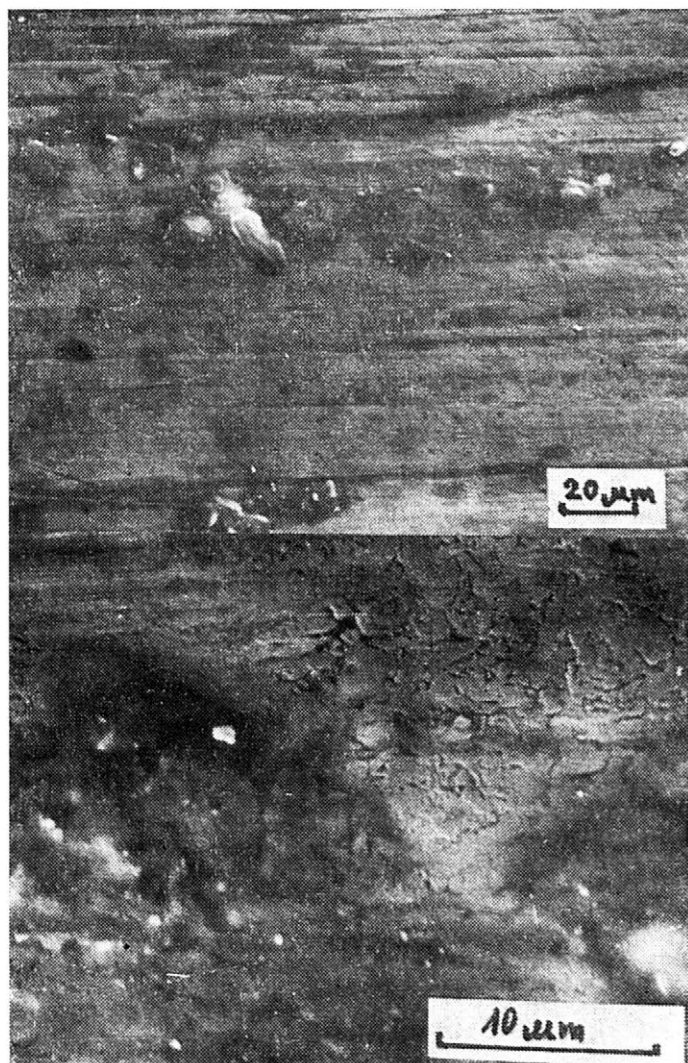
15. Detailní vyšetření povrchu stelitu provedené rastrovacím elektronovým mikroskopem [zvětšeno a) 1000 \times ; b) 3000 \times ] — The examination of stellite surface in detail carried out by scanning electron microscope (enlarged a — 1000 times; b — 3000 times)
