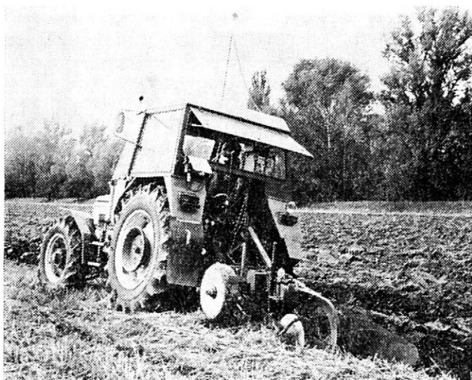
5. Pohled na orební agregát při terénním měření — A view of the tractor-and-plough combination during tillage — field measurement
