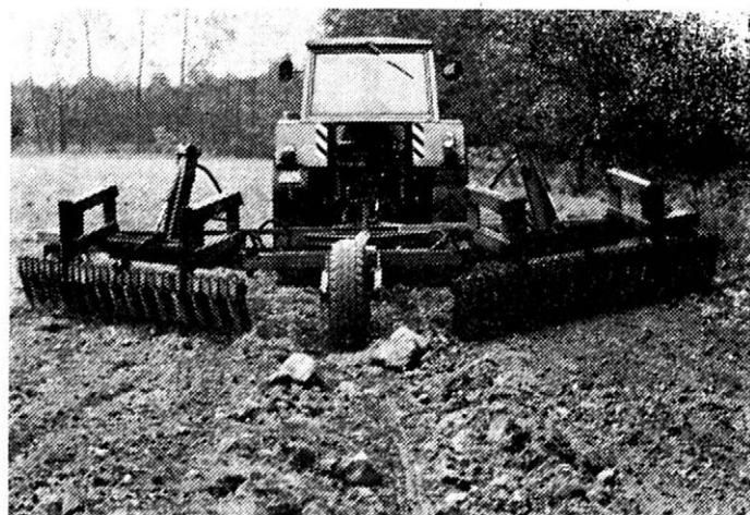
11. Hrabicový řádkovač kamene RKH při polních zkouškách — The RKH rake type rock windrower in the field tests
