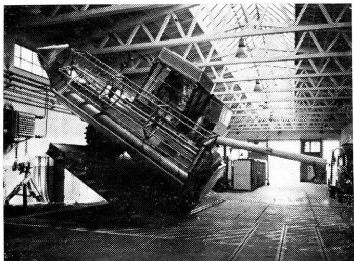
1. Zjišťování statické stability na zkušební stolici — Determination of static stability on the testing bench
