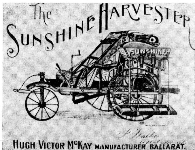
5. Česač klasů s čistidlem Sunshine, postavený McKayovou společností v roce 1901. Stroj byl vybaven zpětným dopravníkem hrubého omlatu a domlacovacím systémem
