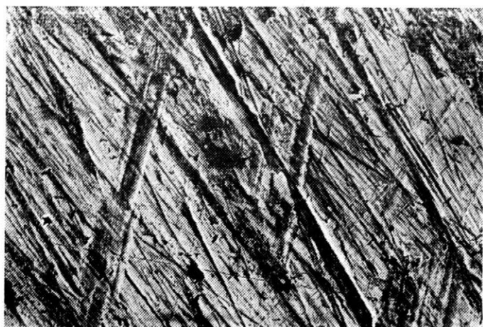
6. Oblasť rovnomerného opotrebenia odhrňovačky rýhami rôznej hĺbky pri 600-násobnom zväčšení na riadkovacom mikroskope — Region of the uniform wear of a mouldboard by furrows of different depths at 600-fold magnification, as observed under the scanning microscope
