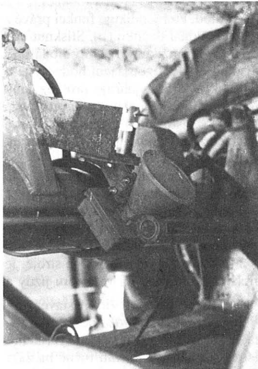
4. Snímač skutečné rychlosti (radar) – Actual speed sensor (radar)
