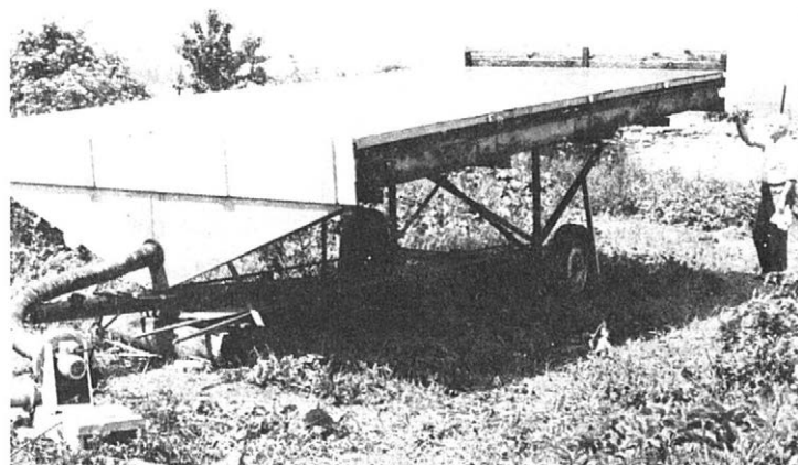
3. Etalon – segment střechy solárního seníku o ploše 20 m 2 používaný k výzkumným pracím ve VÚZT Praha-Řepy – The standard sample (roof segment of the solar hay store 20 m 2 in size) used for investigation at the Research Institute of Agricultural Engineering, Praha-Řepy
