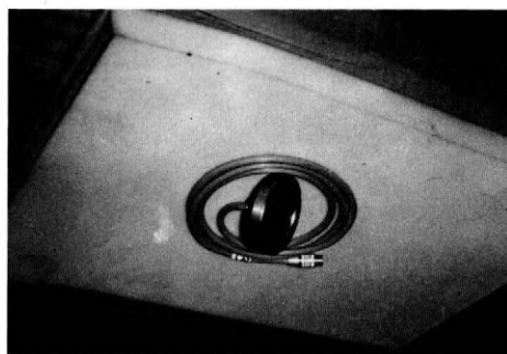
7. Tlakové čidlo (aktivní průměr měřicí tenké desky činí 60 mm) – Pressure cell (active diameter of the measuring thin plate is 60 mm)
